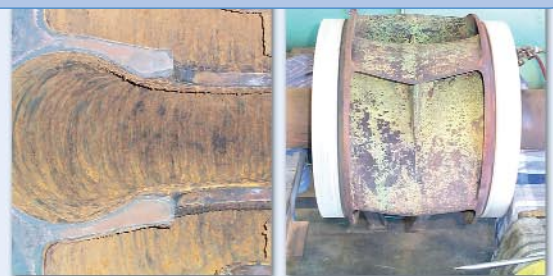
A fedél és a bronz járókerék a felújítás előtt. Az első lépés SA-3 minőségű szemcseszórás a 75 µm-es felületi profil biztosítása érdekében.
