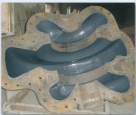
A szivattyúház felújítás után.
