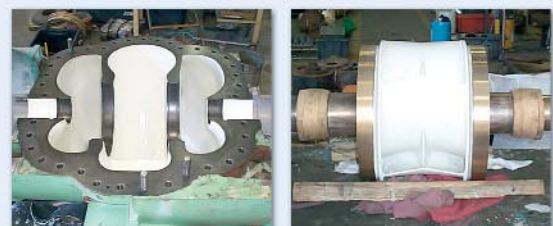
A korrodált és kopott tengely felújítása Loctite® 3478 Superior Metal alkalmazásával. Kikeményedés után méretre munkálással fejeződött be a tengely felújítása. Ezután az összes alkatrész bevonásra került Loctite® Nordbak® 7228 fehér színű ecsetelhető kerámiával (ivóvíz rendszerekben alkalmazhatósági bizonylattal rendelkezik).
