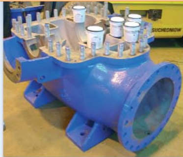
2. kép: A felület szemcseztörés után 75 µm-es profilt kapott
