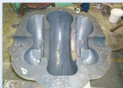
Loctite® Nordbak® 7227 szürke ecsetelhető kerámia bevonat alkalmazása. Az erősen korrodált és kopott felületek Loctite® 7222 kopásálló epoxigyantával kerültek kijavításra.
